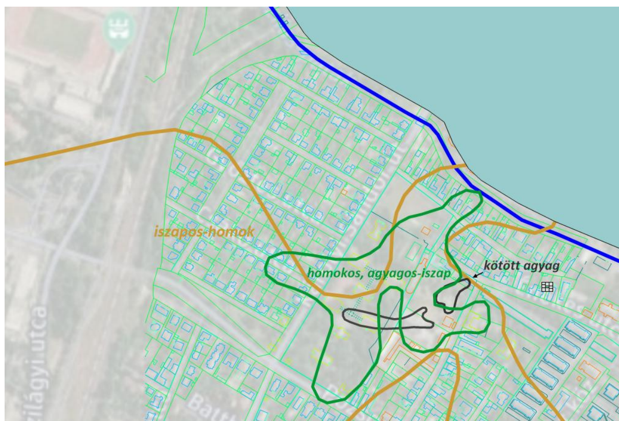
5. ábra A modelltéren alkalmazott zónásított hidraulikai paraméterek (felszíni metszet)
