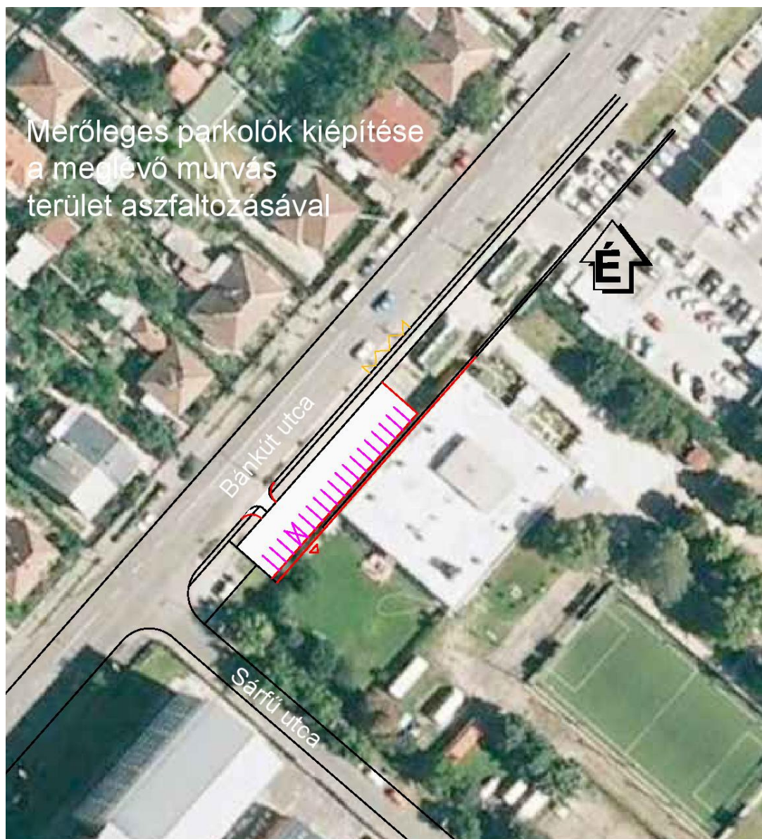
8.5.12. Bánkút utca – Sárfű utca sarkon parkoló építése
